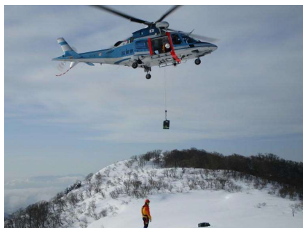
雪害による無線中継所停電に伴う警察用航空機を活用した資機材運搬
